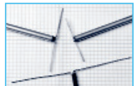
Dipolantennen in Detailansicht
